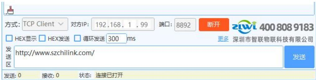
客户 2 建立 tcp 客户端连接，连接电台 2 的 tcp 服务端，ip 为电台 2 的 IP，端口为 8892
