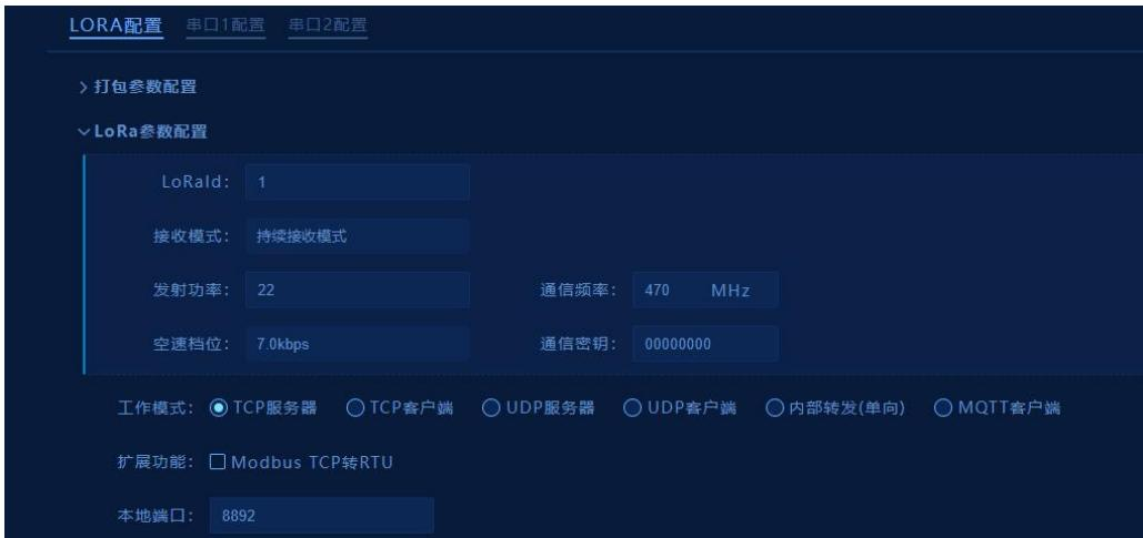
电台 2 的配置如下图所示，注意 LoRa 和串口 1 都需要对应配置
